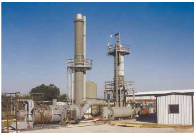
霍尼韦尔 UOP 凯勒特研发测试中心的三级燃烧系统
