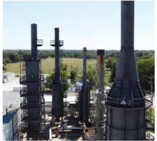
燃烧器试验设施拥有7台测试炉
