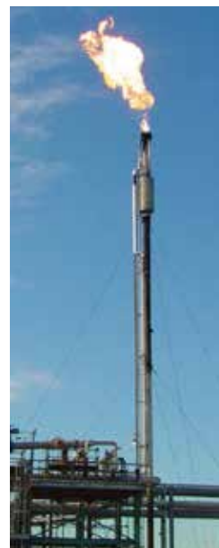
上部蒸汽火炬的火炬测试
